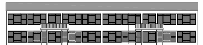
Ansicht Klassentrakt mit Fluchtbalkonen
